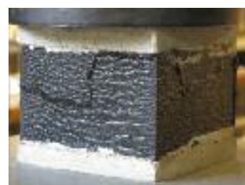
Figuur 1: Centrische drukbelasting op een FOAMGLAS® PERINSUL S-blok met mortellaag ('capping')
